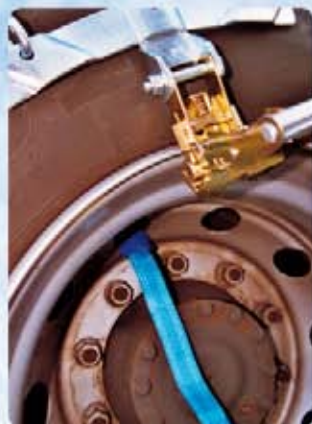
2 Faire ressortir la sangle par l'une des alvéoles de la jante.
