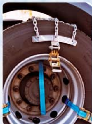
1 Poser la chaîne sur la partie supérieure du pneu : le cliquet sur la face externe, la sangle sur la face interne.
