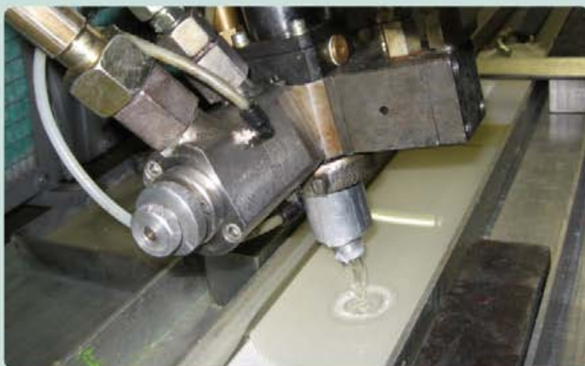
❖ Réalisation en cours d'un fourreau polyuréthane POLYSAFE 2 faces.
