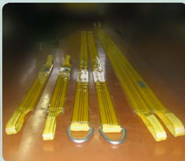
❖ Séchage en cours, d'enduction sur sangle : 48 heures minimum sont nécessaires à la bonne tenue du produit.
